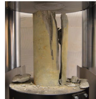
Ein Kraftpaket bei der Arbeit, Bruchbild nach Versuch
