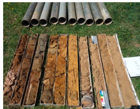
Kernbohrung beim unteren Dammstandort – Beprobung und Dokumentation
