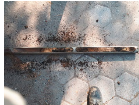
Bohrschuppe mit Bohrgut vom Parkplatz Heukoppel
