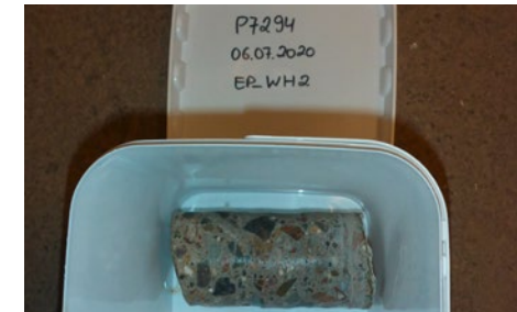
Kernprobe aus der Außenwand einer Lagerhalle
