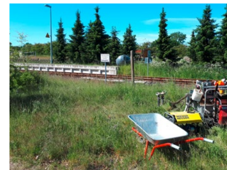
Baugrunduntersuchung beidseitig der Gleise außerhalb des Gefahrenbereiches
