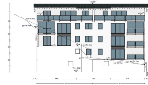
Querschnitt des Bauvorhabens mit Geländeoberkante vor Baubeginn
