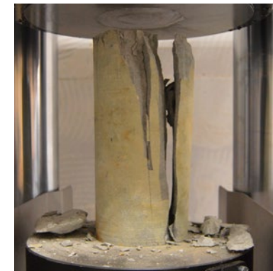
Ein Kraftpaket bei der Arbeit, Bruchbild nach Versuch
