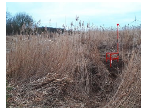
Errichtete Grundwassermessstelle im Spülfeld
