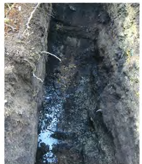
Abb. 5: Klärschlamm, Boden, Bauschutt mit „ölicher“ Flüssigkeit im Becken 6
